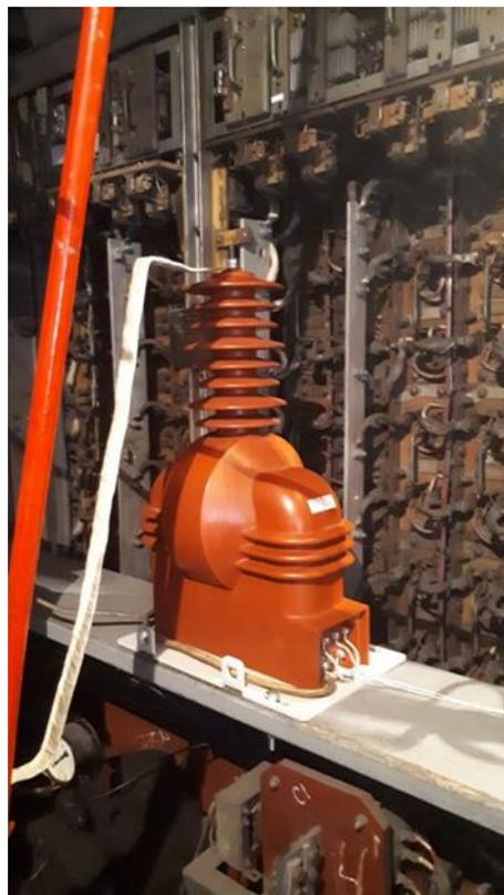
**Рисунок 4.4 – Силовая часть испытательного стенда с измерительным трансформатором
