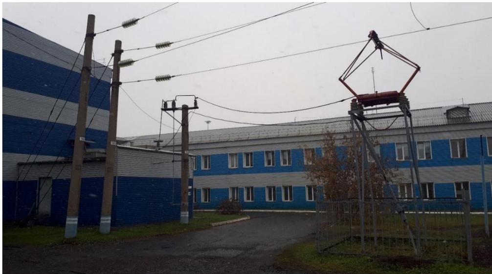
**Рисунок 4.2 – Токоприёмник электровоза, питание испытательного стенда от контактной сети**
